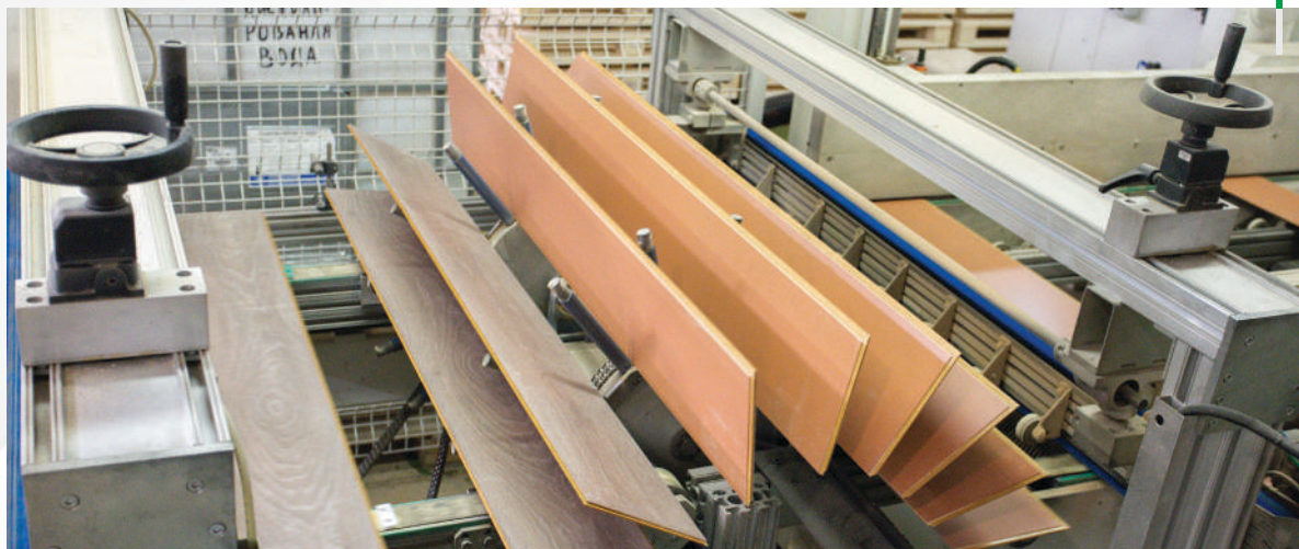
Участок нанесения антистатической жидкости на панели
